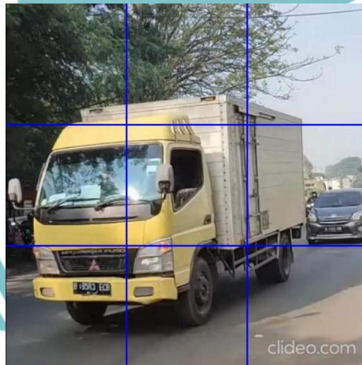
Gambar 2. 3 Ilustrasi Pembagian Grid Model YOLO
