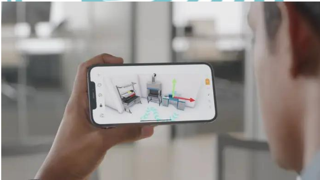
Gambar 2.1. sensor LiDAR pada smartphone
