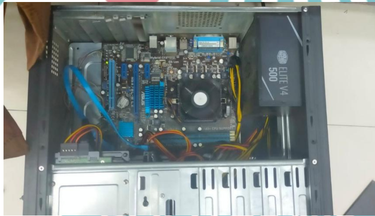
Proses Perakitan Perangkat Keras Server dan Penyiapan Media Penyimpanan Hardisk untuk Konfigurasi RAID 1.
