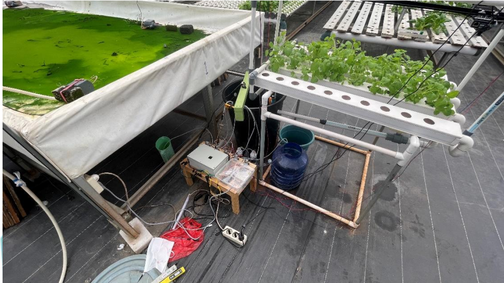
Gambar 4. 8 Penempatan Node Sensor IoT pada Media Hidroponik
