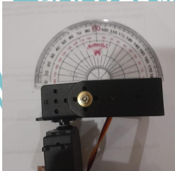
Gambar 4. 27 Pengujian Akurasi servo dengan penggaris busur
