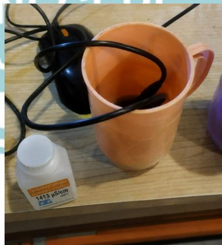
Gambar 4.22 Pengujian Awal Sensor TDS
