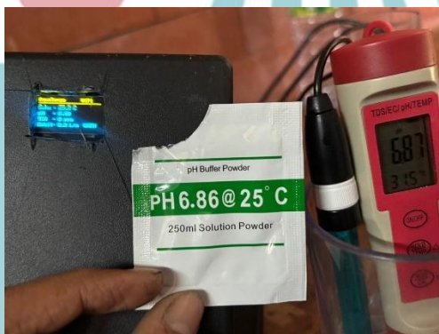
Gambar 4.21 Pengujian Awal Sensor pH
