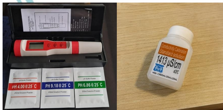
Gambar 4.20 PH TDS EC Temperature Meter Tester ATC EZ9908, CRM pH dan CRM Konduktivitas
