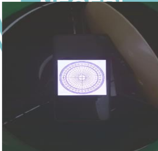
Gambar 4.33 Pengujian Akurasi servo dengan busur digital 360°
