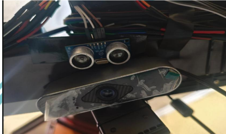
Gambar 4.11 Pemasangan sensor ultrasonik HC-SR05 dan kamera USB
